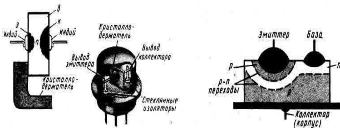
Рис. 2 — Устройство и конструкция сплавного слева и диффузионно — сплавного справа транзистора структуры p-n-p .
